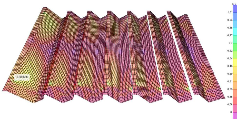
*Cuantías de armadura necesarias (m<sup>2</sup>/m) en la cara inferior de los paneles para la dirección transversal*
