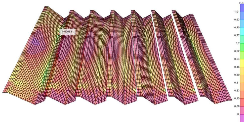
*Cuantías de armadura necesarias ( $m^2/m$ ) en la cara superior de los paneles para la dirección transversal*
